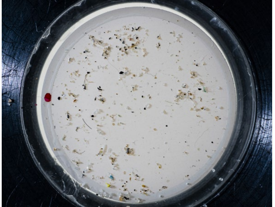
Deeltjes van 100 tot 500 \mu\text{m} uit oppervlaktewater, gevangen op een filter na behandeling om organische deeltjes te verwijderen. De identiteit van de deeltjes wordt vervolgens vastgesteld met een fourier-transformatie infrarood spectroscopie (FTIR).
