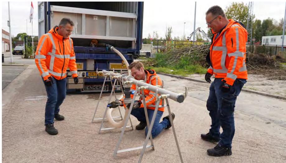
Foto: Nooddrinkwateroefening van Vitens (2024). Het nooddrinkwater wordt vanuit een tankwagen aan een kraanstel gekoppeld van waaruit mensen nooddrinkwater kunnen tappen.
